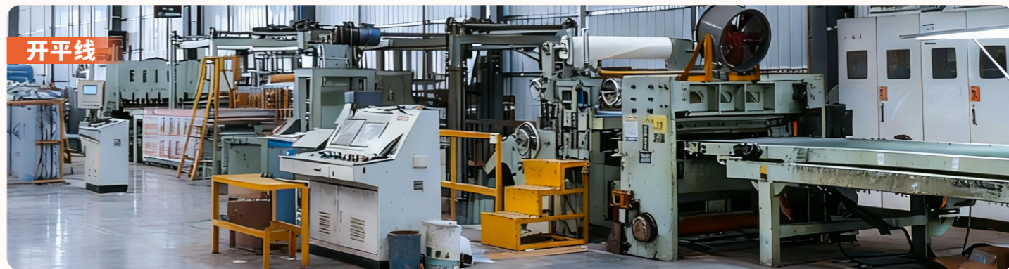
采用自动化开卷—矫平—定尺—剪切全流程设备，将卷料的板形、平整度、厚度偏差控制在严格工艺范围内。且可按客户的需求，裁剪成不同尺寸的平板。
