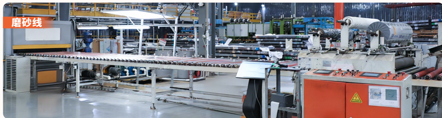
通过不同号数的砂辊、砂带对不锈钢表面进行磨砂加工处理，在不锈钢表面形成丝状、凹凸不平的纹理纹路效果。
