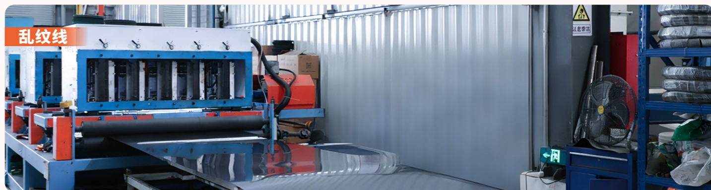
通过多组高速交叉运行的磨轮实现非方向性肌理，纹理扩散无规律但均匀一致。
